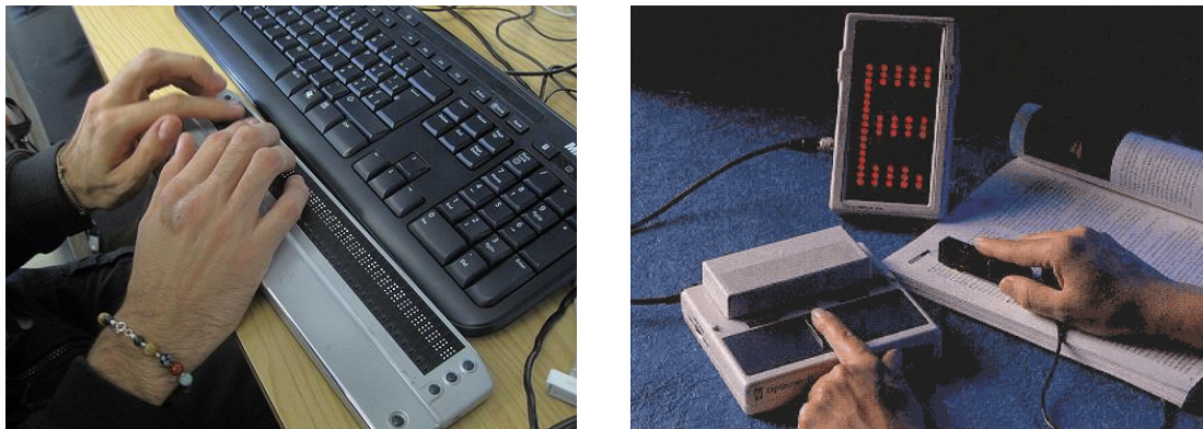
Figure I-9 A gauche, plage braille permettant la lecture sur ordinateur ; à droite, dispositif Optacon.
