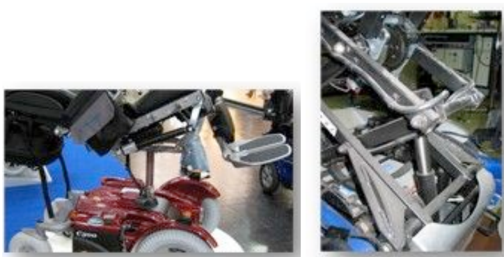
Figure 164. Photos d'un système de lift avec vérin (à gauche) et de lift avec croisillons et vérin (à droite)
