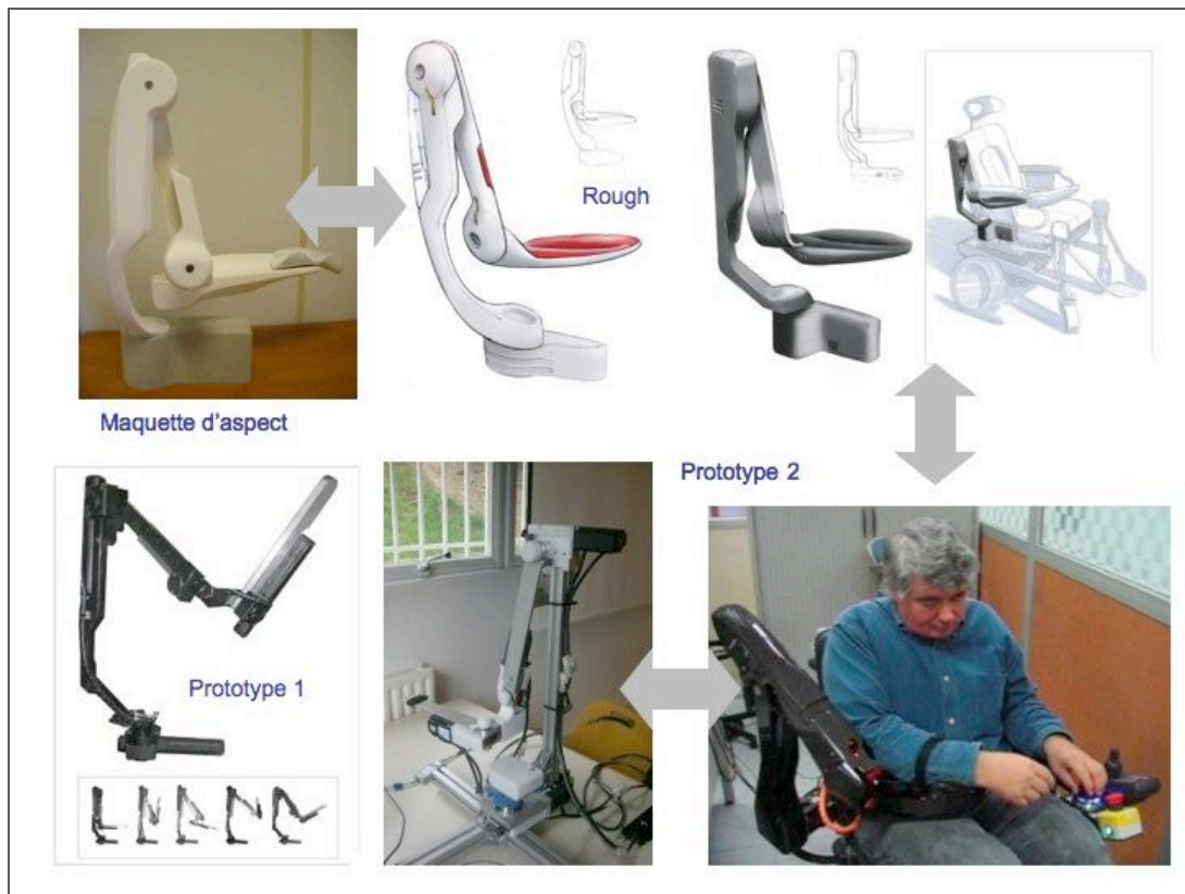
Figure 156. Evolution des représentations intermédiaires du produit: les concepts d'exosquelettes (affirmé et intégré) et la maquette d'aspect du concept affirmé (en haut), le prototype fonctionnel 1 (en bas à gauche) et le prototype 2 design intégré (en bas à droite)
