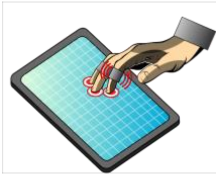
Figure 3. Principe des dispositifs à porter sur soi : l'utilisateur porte de petits dispositifs contenant des stimulateurs tactiles (e.g. gants, bagues, stylet). Un écran tactile détecte le ou les points touchés. Les dispositifs émettent alors des stimulations pour simuler les effets tactiles du ou des points touchés.
