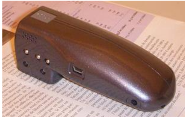
Figure 8 Le Top-Braille permet de transcrire les caractères d'un document écrit à l'aide d'une cellule Braille.
