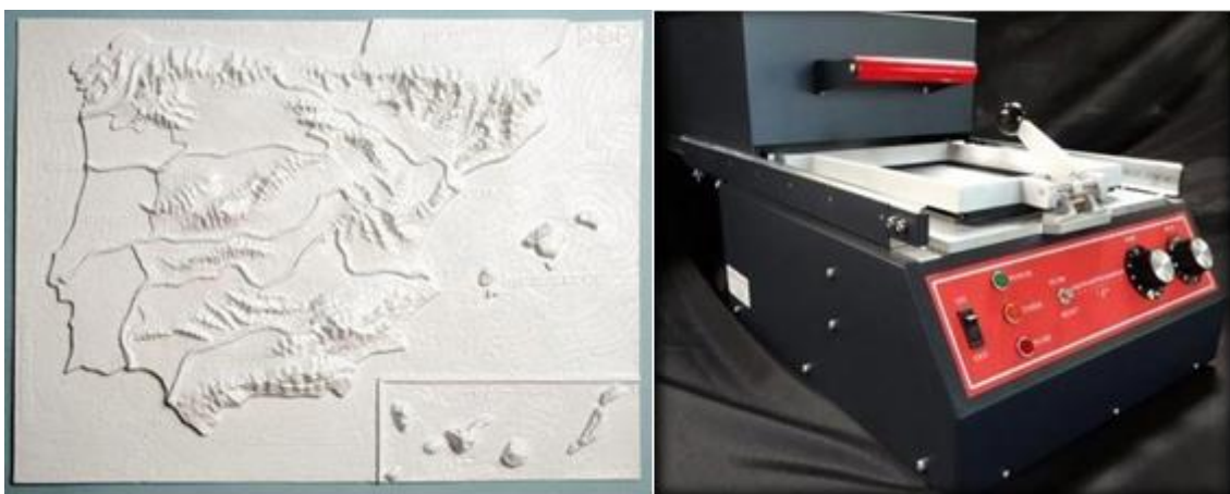
Figure 11 À gauche : une carte obtenue par thermoformage, à droite : une machine de thermoformage EZ Form Braille Tactile Brailon.
