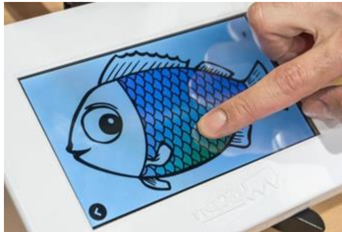
Figure 20. La tablette HAP2U permet de simuler les sensations tactiles d'une image (ici, les écailles d'un poisson). Cette tablette a cependant été conçue pour augmenter l'interaction d'utilisateurs voyants.
