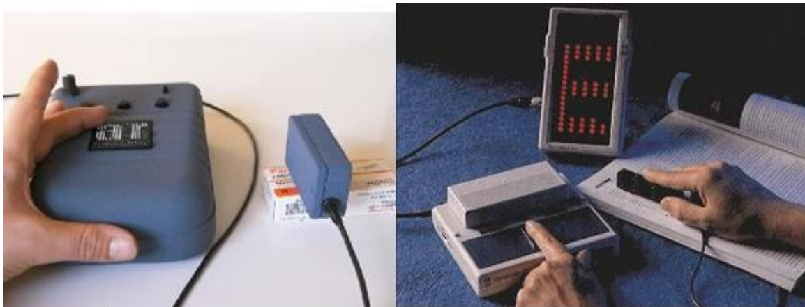
Figure 18 Gauche : OPTACON 2 : l'utilisateur pose son doigt sur une matrice de taxels et parcourt l'image à l'aide d'une caméra. L'écran montre l'image tactile transmise. Droite : le VideoTIM3, plus récent, fonctionne sur le même principe.
