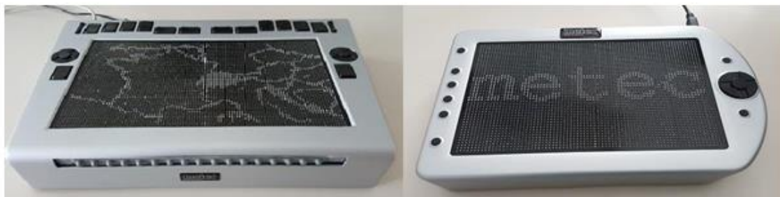
Figure 15 Deux tablettes tactiles produites par Metec : Hyperflat (à gauche) et Hyperbraille S (à droite). La surface est recouverte de picots déplacés par des lamelles piezo-électriques, permettant d'afficher une image tactile.
