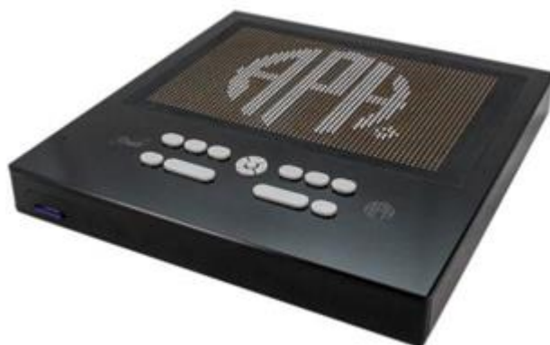
Figure 16. La tablette Graphiti réduit le nombre de moteurs afin de réduire l'encombrement et le coût. La hauteur des taxels est variable, permettant d'afficher différentes hauteurs.
