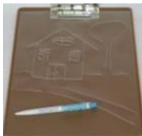
Figure 10 Planche à dessin sur feuille molle : une feuille de plastique est posée sur une surface molle. À l'aide d'un stylet, d'un poinçon ou d'une roulette à dessin, il devient possible de tracer des points et des lignes pouvant être sentis au toucher
