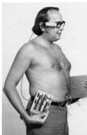
Figure 24. TVSS : prototype de système de substitution sensorielle de Bach-y-Rita. Les images captées par une caméra sont simplifiées et transmises par une plaque couverte de vibreurs posée sur le ventre.
