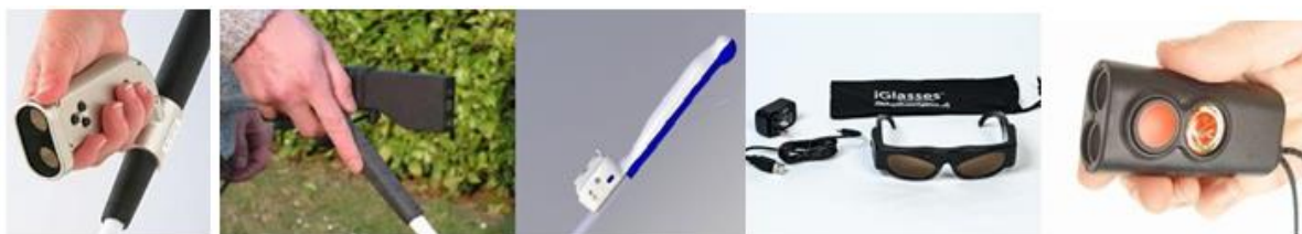
Figure 26. Exemples d'outils d'aide à la navigation (gauche à droite): K-sonar (ultrason et transmission audio), le Télétact (télémètre laser et vibrations), une canne intelligente (par Phoenix), les iGlasses de Ambutech, le Miniguide Mobility Aid (ultrasons vibrations)
