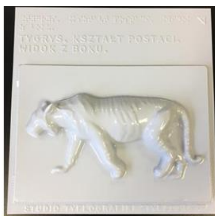
Figure 7 Plaque pédagogique obtenue par thermoformage. Le texte est écrit en Braille (en haut) et par une représentation par points en polonais (en dessous) (source : Specjalny Ośrodek Szkolno - Wychowawczy dla Dzieci Niewidomych im. Synów Pułku, - Ecole pour les enfants déficients visuels à Owinska, Pologne).
