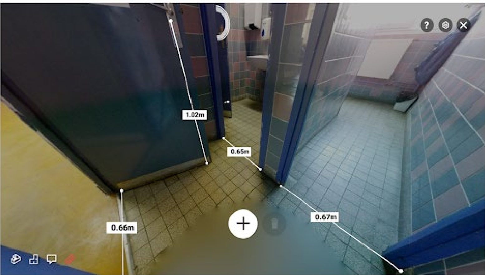
Figure 19: Prises de mesures via l'outil de visite virtuelle en ligne Matterport - Sanitaire SN5. Source: Equipe UP, Laboratoire TVES, 2022
